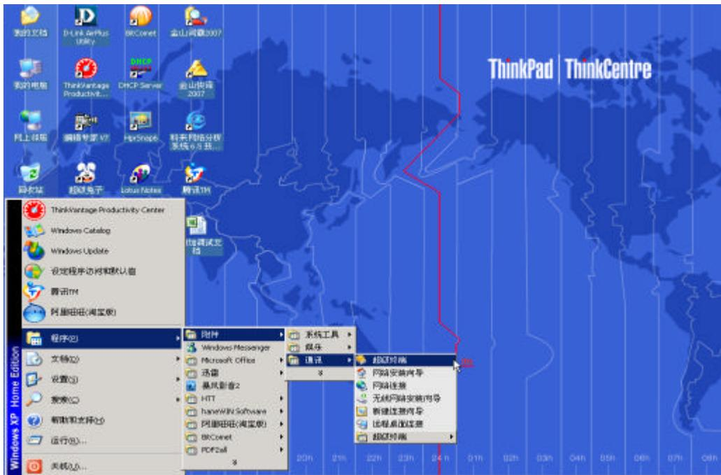
设置超级终端的端口属性，进入交换机配置界面。
